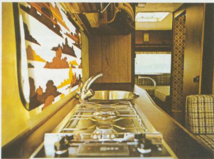
Küche mit Druckwasserarmatur
